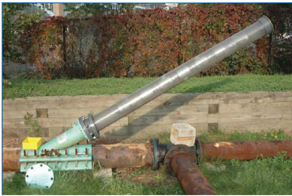
شکل ۴ - نقطه تزریق روبات به خط لوله
